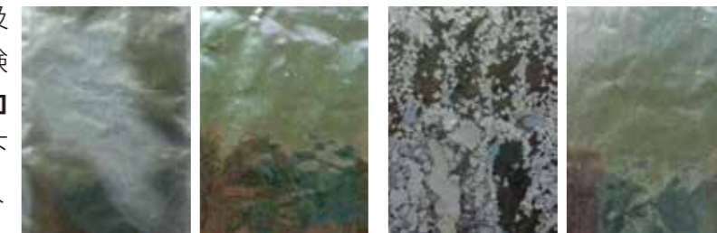
無処理アルミ箔 腐食(白化)発生 スタイロスター™ 腐食(白化)なし 無処理アルミ箔 腐食(白化)発生 スタイロスター™ 腐食(白化)なし
