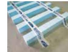
1層目はスタイルフォーム™をリン木形状にカットし、不織布テープで連結したスタイルライナー™を敷き込み、2層目はスタイルフォーム™で全面敷設を行い、深型湧水処理ならびに軽量嵩上げを実現。必要最小限のアンコ量と押えコンクリート量、配管スペースの確保、現場廃材の低減等、コストメリットや施工上のメリットが大きい深型湧水・軽量嵩上げ工法です。
